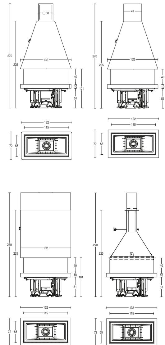
La dimensione di 2,70 m indicata nei disegni tecnici si riferisce alla misura a listino. L'altezza minima necessaria per l'installazione è di 2,50 m. Tubo, supporto e copritubo possono essere forniti per altezze superiori su progetto personalizzato.
